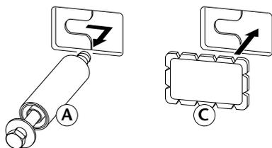
3. Die drei Abdeckkappen **C** (aus dem Beipackbeutel) auf die Öffnungen in der Rückwand setzen und mit einem Hilfswerkzeug (z.B. Schraubendreher) hineindrücken.
