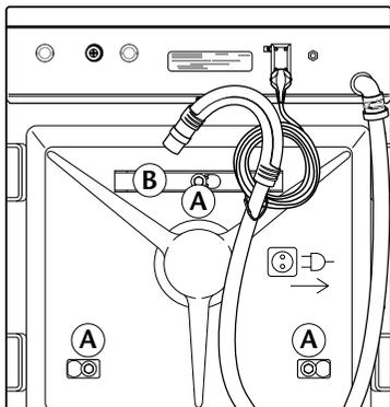
2. Die Schrauben **A** zur Seite schieben und mitsamt Abstandshülse herausziehen; Quertraverse **B** abnehmen (falls vorhanden).
