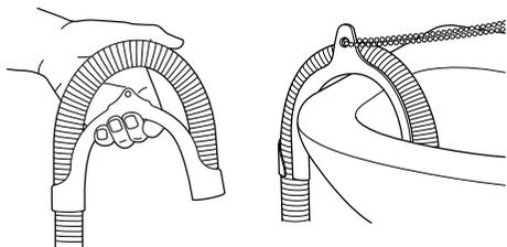
2. Den Ablaufschlauch mit dem Schlauchhalter über den Becken- bzw. Wannenrand hängen und gegen Abrutschen sichern – z.B. mit einer Kette am Wasserhahn befestigen.
