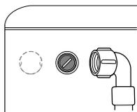
2. Das andere Ende des Zulaufschlauches „gut handfest“ am Wasserhahn anschrauben.
