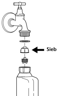
4. Das Sieb in der Rückwand (außer bei „Aquistop PLUS“) mit einer Kombi- oder Spitzzange herausziehen, reinigen und wieder einsetzen.
