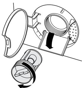
**!** Bei gefüllter Trommel (z.B. bei einem Stromausfall) können bis zu 20 Liter Wasser aus dem Gerät laufen!
